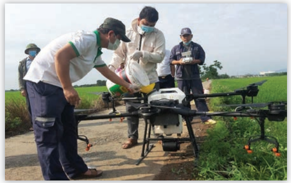
Hình 5.3. Phun thuốc bảo vệ thực vật bằng máy bay không người lái (huyện Thạch Thất)
